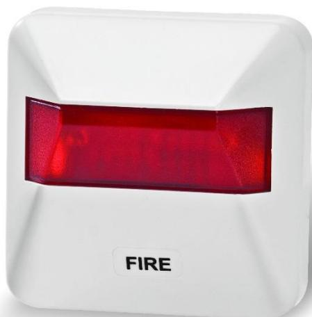
ریموت اندیکاتور RX-99 هشدار دهنده‌ی بصری برای اعلان محل وقوع آتش می‌باشد. این المان با دارا بودن شدت نور بالا، حتی در حالت آتش‌سوزی و وجود دود، قابل رویت بوده و به کاربر محل آتش را نشان می‌دهد. این ریموت اندیکاتور، با اتصال به خروجی هر دتکتور آدرس‌پذیر و کانونشال، پس از تشخیص فایر توسط دتکتور، فعال می‌شود.
